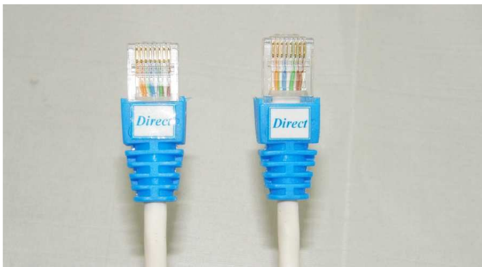
สาย LAN ซึ่งต่อผ่าน HUB จะใช้สายแบบ Direct
