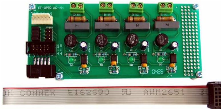
ตัวอย่างชุด ET-OPTO-ACIN4 สำหรับประยุกต์ตรวจจับไฟ AC Line 220VAC
