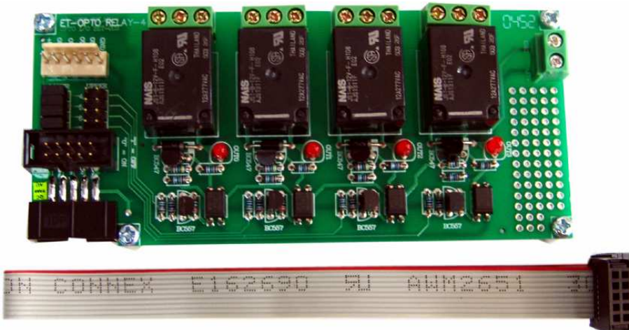
ตัวอย่างชุด ET-OPTO-RELAY4 ใช้สำหรับประยุกต์ใช้ควบคุมเปิดปิดอุปกรณ์ไฟฟ้าแทนสวิตช์
