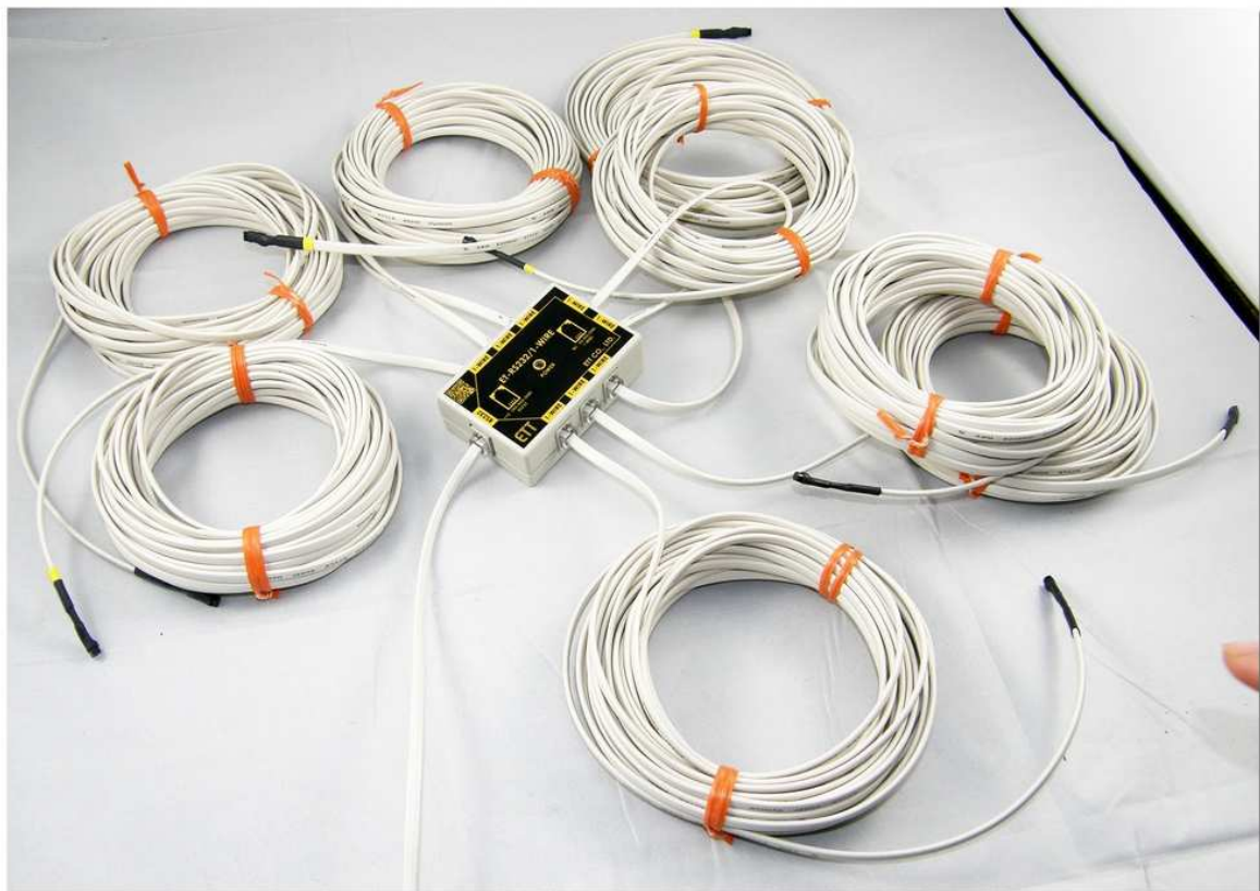
รูปแสดง ตัวอย่างการเชื่อมต่อ OPTION ชุด ET-RS232/1-WIRE กับ Sensor วัดอุณหภูมิ
